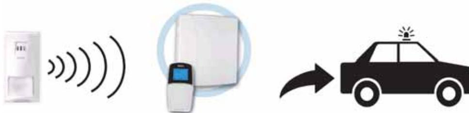
Rilevazione. ▶▶▶ Sistema in condizione di allarme ▶▶▶ Segnalazione di allarme inviata alla centrale operativa .
